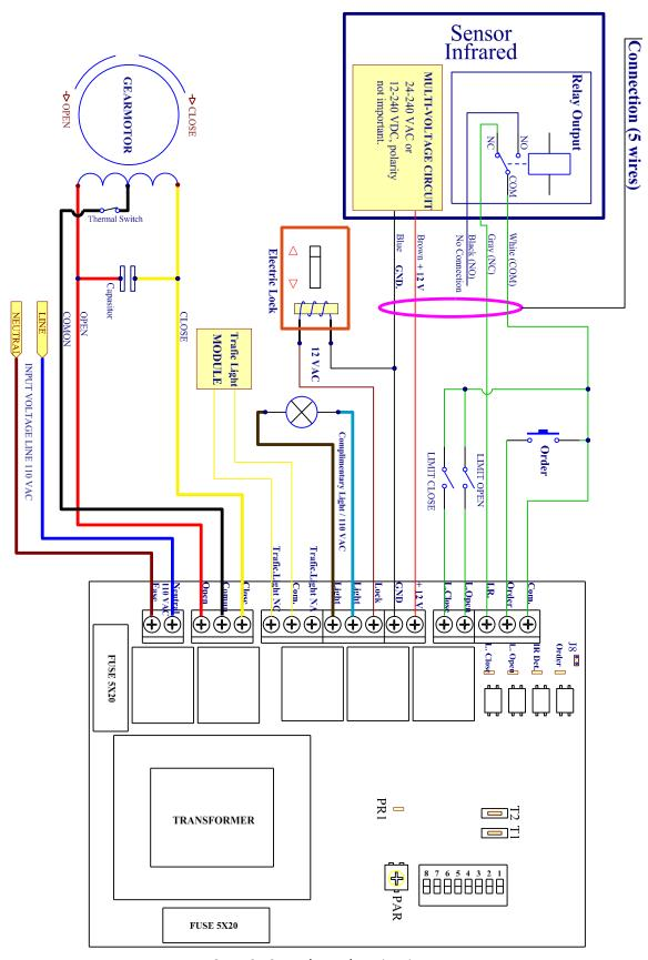
FIG Nº 2: Complete Electric Diagram
